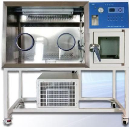
恒温培养箱内箱材质为SUS304不锈钢 / 7"彩色触摸屏P.I.D.控制器, 中英文显示
